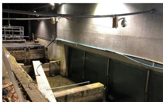
図 2：実験時の様子。水槽上部にカメラを設置し、サケの行動を観察した。
